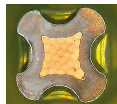
Querschnitt eines Vierdorncrimps Cross-section of a 4/8 indent crimp
